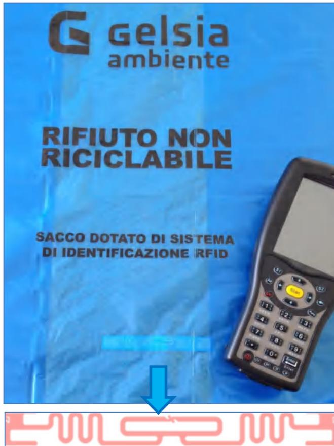
La tecnologia Radio Frequency IDentification è utilizzata per l'identificazione univoca di dati e la loro trasmissione automatica.
