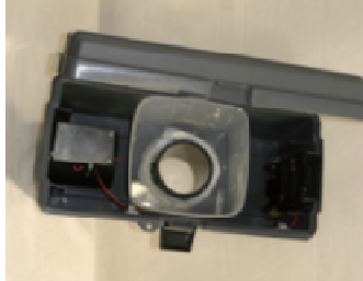
Figura 4: parte superiore della trappola Gravid assemblata.
